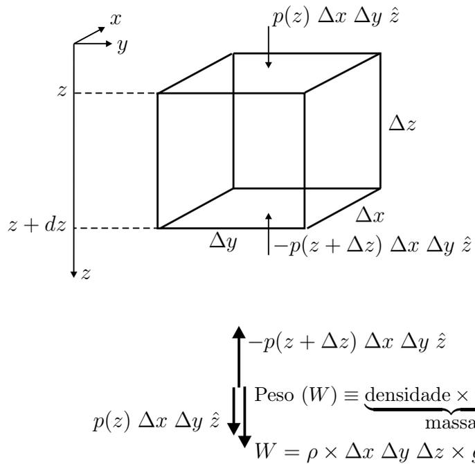
**Figura 1.7:** Elemento de volume utilizado na discussão da pressão em função da profundidade, na presença de um campo gravitacional.
